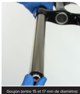
Goujon (entre 15 et 17 mm de diamètre)
