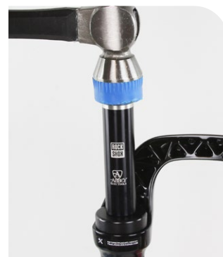
Outil d'installation des joints anti-poussière
