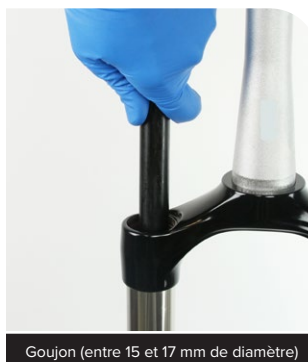
Goujon (entre 15 et 17 mm de diamètre)
